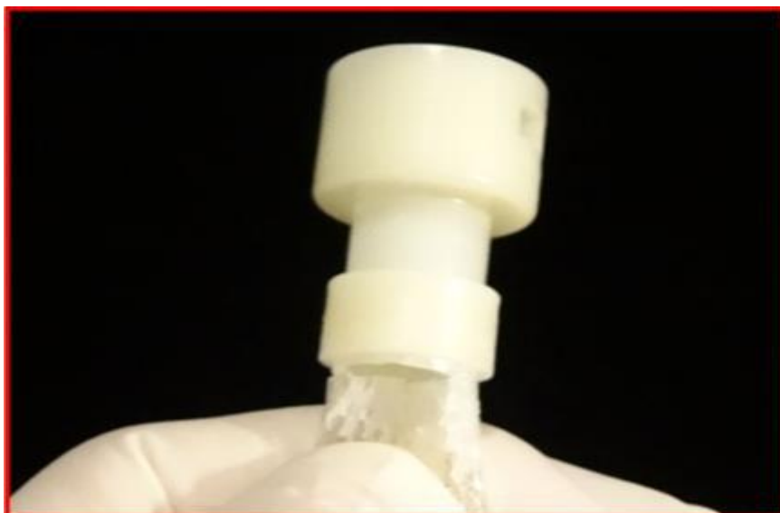
図 6 : 米国工場の全品加圧検査にて不具合品が発見された
