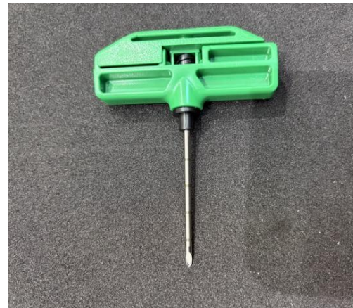
写真 2：内針と外針の先端形状一致した状態
